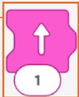
**Mover para a frente** - Este bloco move uma base motriz para a frente em um número definido de rotações da roda. Para alterar o número de rotações das rodas, digite um número diferente no bloco. Digitar "1" no bloco fará com que cada roda gire uma rotação completa.
