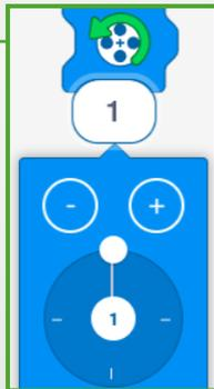
**Executar motor no sentido anti-horário** - Este bloco fará com que o motor(es) conetado(s) ao Hub seja executado no sentido anti-horário. A velocidade pode ser alterada usando o bloco de velocidade do motor.
