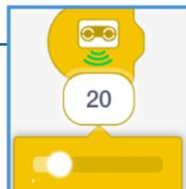
**Sensor de distância** - Deteta a distância entre a frente do sensor e um objeto. O bloco irá executar todos os blocos conetados a ele, se o sensor identificar um objeto mais próximo do que a distância escolhida. Este sensor pode "ver" até 200 cm à frente. O número que for inserido neste bloco indicará o limite no qual ele reagirá ao objeto.
